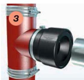
Отметить на соединяемой трубе глубину входа. Покрыть антиадгезионным средством и вставить трубу в отверстие.
